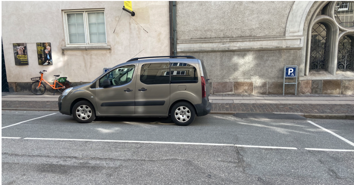
Figur 7.10 Handicapparkeringsplads til pladskrævende køretøjer med manøvreareal ved siden af og bag bilen til kørestolsbrugere.
