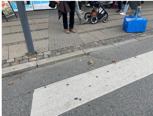
Figur 4.4 Højt kantstensopspring ved retningsfelt og nedsænket kantsten med rampe og opmærksomhedsfelt
